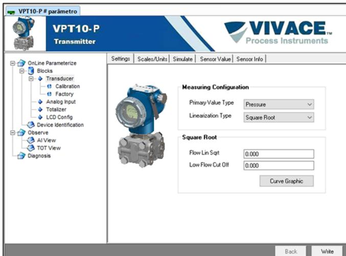
Figura 3.9 – Tela de configuração do VPT10 PROFIBUS.
